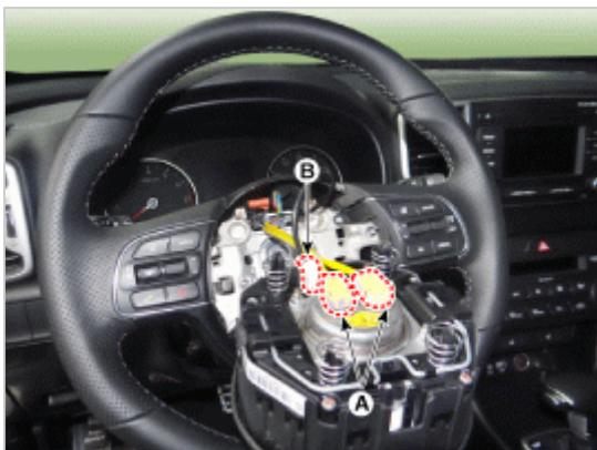
把拆卸的空气囊总成存放在干净、干燥的地方，放置时要装饰板盖朝上。
