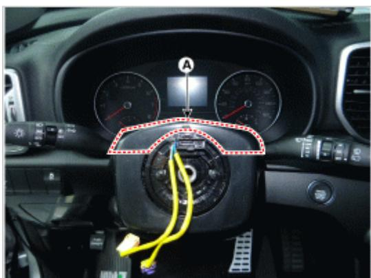
7. 拧下固定螺钉，并拆卸下护罩 (A)。
